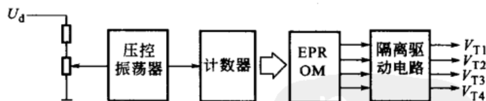
图 8-19 变频控制电路原理
